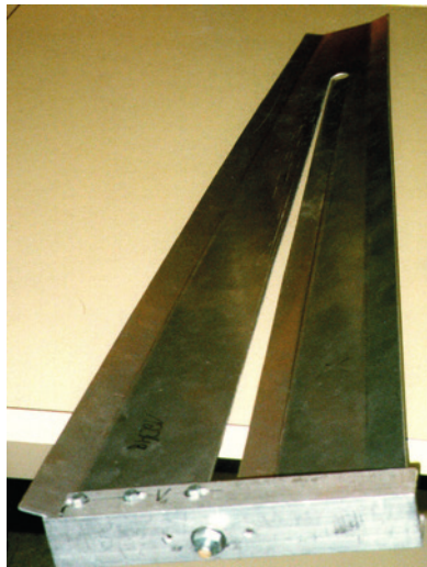
Das Schlitzrotorblatt mit zwei Blattwurzeln. Es lässt sich in wenigen Produktionsschritten aus einfachem Blech herstellen und benötigt keine aufwendige Profilierung, um die Luftströmung zu nutzen. Dies geschieht hier durch die verschiedenen Anstellwinkel des Gesamtblattes, der beiden Blathälften und der Abkantungen. (© A. Khammas)
