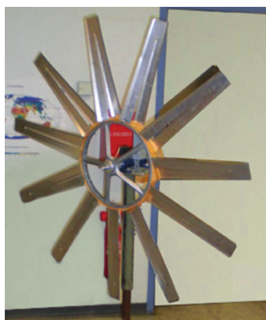
Versuchsrotor am 2. Oberstufenzentrum Berlin, wo die Lehrer und Schüler extra einen Windkanal bauten, um das Rotorblatt zu vermessen und zu optimieren (© A. Khammas)
